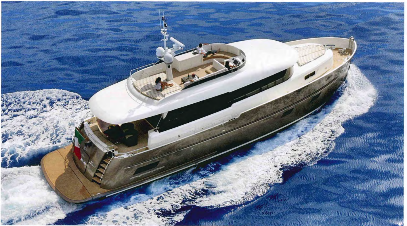
In jeder Hinsicht sparsam: Vripack sorgte bei der Konstruktion für wenig Stahlverschnitt. 60 Liter pro Stunde reichen der Gamma 20.
