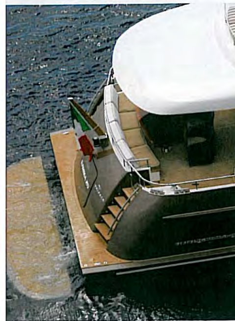
Wellenschneider - der scharfe, hohe Vertikalsteven weist Spritzwasser ab (o.). Tenderplatz - die absenkbare Badeplattform von H+B Technics (u.).
